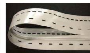
ベルトに穴加工(写真では長穴)してサクション(吸着)搬送に使用。
