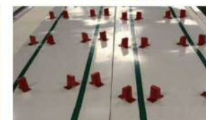
搬送物の位置決め目標にするマーキング(直線)と搬送物を固定する棧の組合せ。
