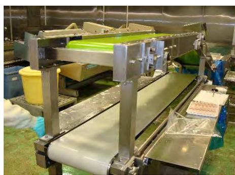
一般的な中性洗剤による洗浄を施した直後の写真です。この後、エタノールを浸み込ませた布にて拭取りし、同薬品を浸漬した布を被せて清浄を保持管理しております。通常のTPUでは濃度により、早期に問題が発生する可能性もありますが、この様な用途にもご使用頂けます。
