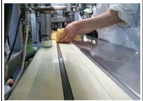
次工程が蒸し工程であることから、投入部分の温度が高く、また、油揚げの油がベルトに多く付着するアプリケーションです。耐熱性、耐オレイン酸性といった特性を活かして本ベルトがご使用頂けます。
