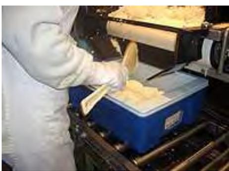
炊き立ての米飯を搬送してプラスチック容器に詰めている写真です。米飯の温度が高いこととベルトに貼り付いてしまうため、スクレーパを使用しており、一般的なTPUベルトは適さないアプリケーションです。耐湿熱性、耐候性を活かして、この様な用途にもご使用頂けます。
