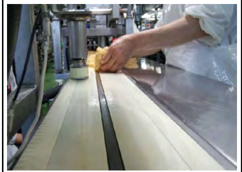
油揚げ蒸し工程送り用途
